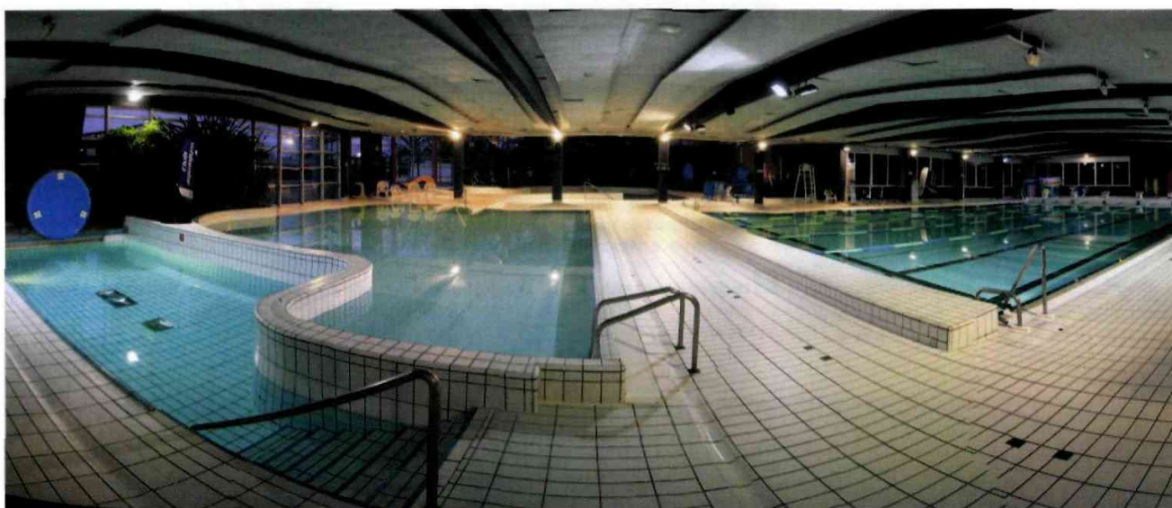
Malgré la norme NF EN 12193, qui préconise des IRC de 60, une valeur supérieure à 80 est plus agréable. D'autant qu'elle est facilement obtenue avec les lames à présent disponibles. (Doc. Piscine Transat à Bihorel/Japac Architecture/Vert Marine)
